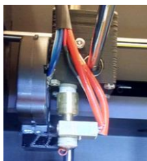
Der Extruder, schmilzt das Material für den Druckvorgang. Foto: xBot 155,
